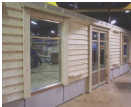
Ferdig element før transport.
