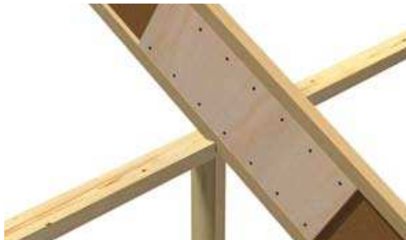
D21 Ende-/midtopplegg på bæring, liten garp
